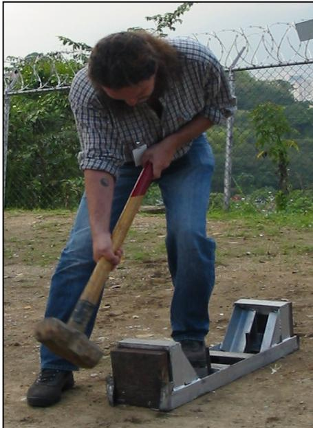
Figura 3.8. fuente sísmica empleada para generar el campo de ondas S.
